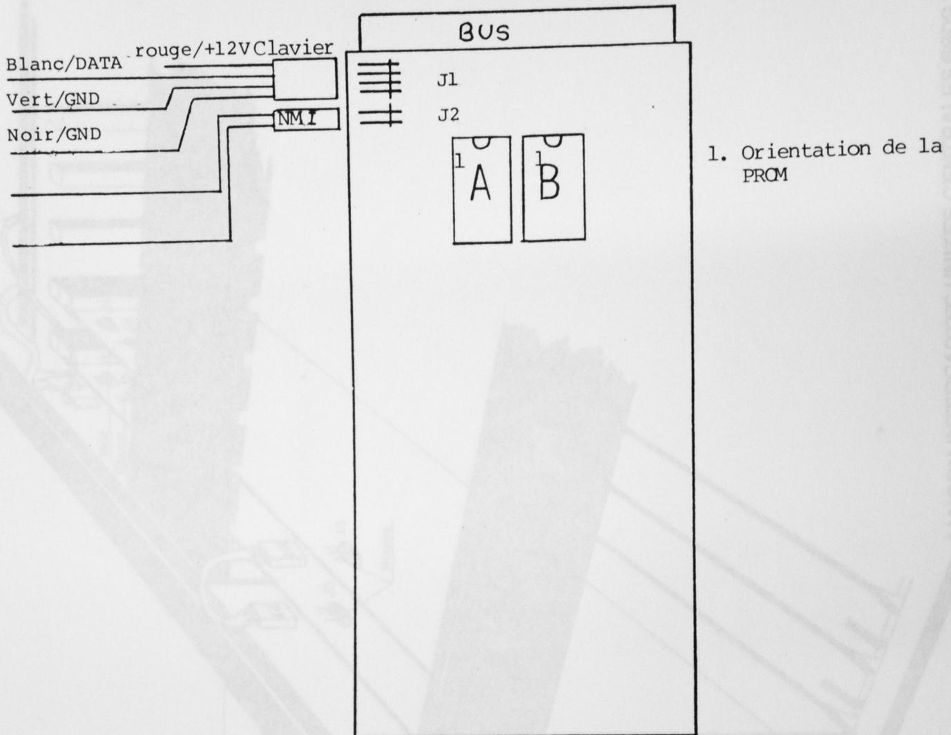
Lorsqu'on passe d'une configuration 1 ou 2 (sans floppys), à une configuration avec disques, il faut placer sur la carte unité centrale 6809 2 Mhz, la PROM P3 en A ( mémoire morte contenant moniteur 25 X 80, contrôleurs disques, graphique ) en lieu et place de la PROM P0 et supprimer la PROM P1 se trouvant en B. La PROM P3 se trouve alors en A sur la carte Unité Centrale, B est vide (B pourra recevoir l'extension P4 micro-terminal).
