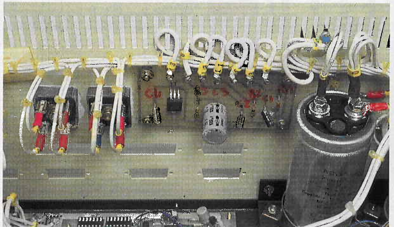
L'alimentation et les câbles de liaison avec la carte « mère ».
