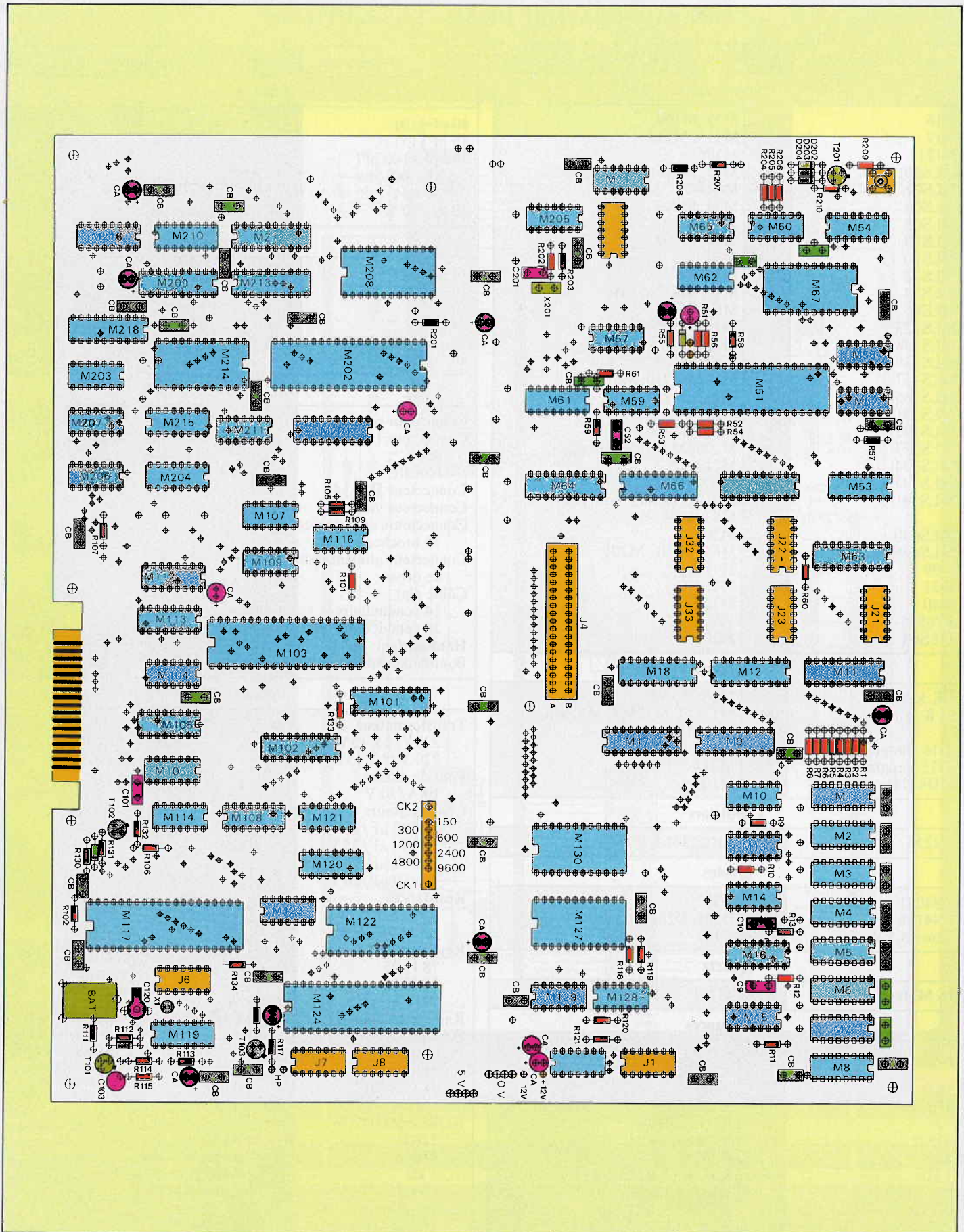
Fig. 1. -- Schéma d'implantation des composants sur la carte « mère » de Vegas.
