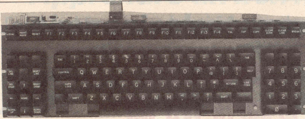
Photo 1. - Le clavier 117 touches proposé pour la version « haut de gamme » de l'ordinateur individuel.
